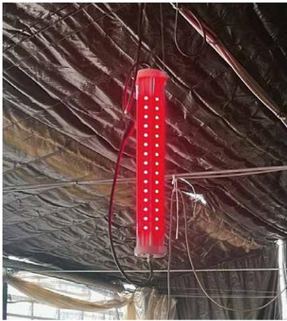
写真 輪ギクの生産現場で使用されている赤色LED
