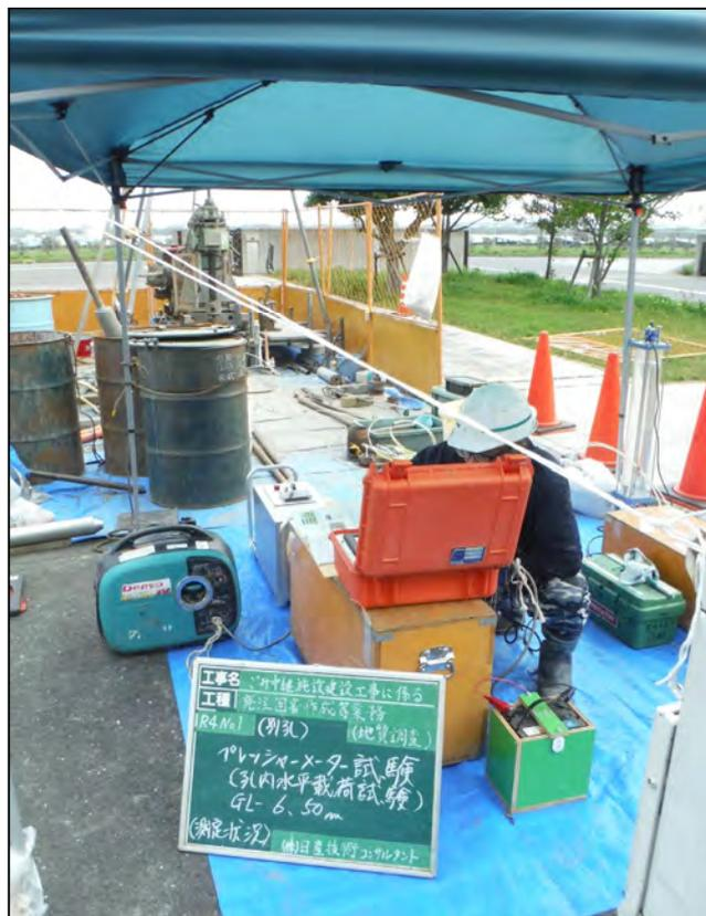
プレッシャーメーター試験(孔内水平載荷試験)
