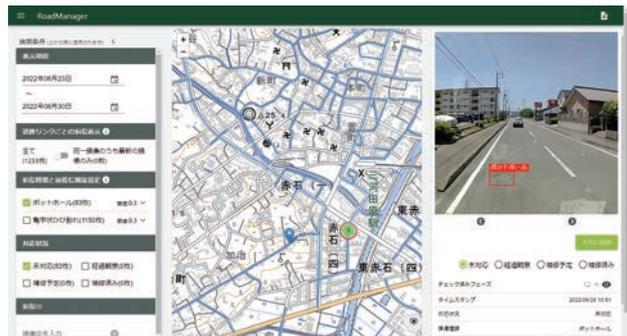
▲ドライブレコーダーからデータを収集して損傷場所を可視化
