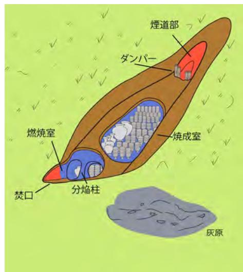
図17 渥美窯の窯体構造イメージ図
