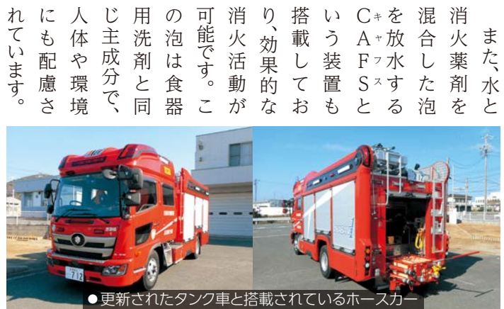
●更新されたタンク車と搭載されているホースカー
