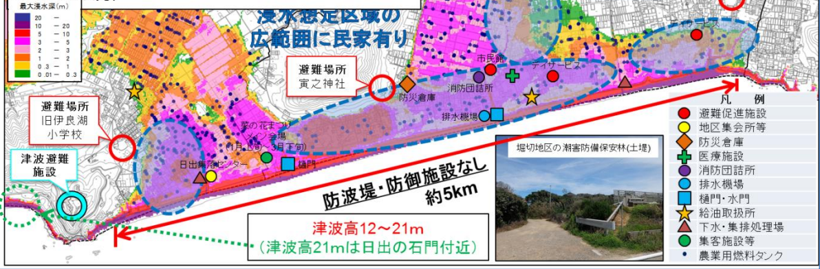
図 2-29 想定される被害状況等 (日出・堀切・小塩津)
