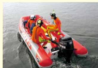
▲【ゴムボート】長さ3.47m、幅1.80m、定員6名 【船外機】4ストロークエンジン、最大出力22.1kW(30馬力)
