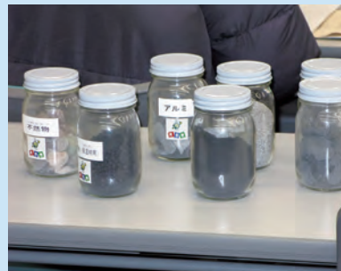
炭化炉から回収した製品。アルミや鉄などの金属類はリサイクルへ。石などの不燃物は市の最終処分場へ。
