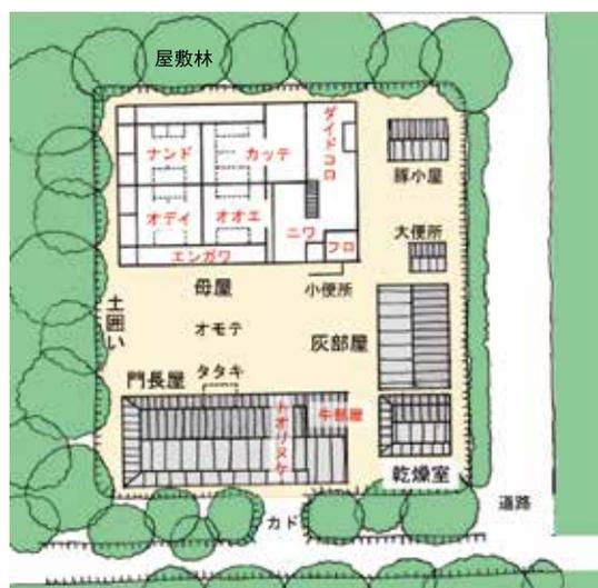
図2 表浜の一般的な農家の母屋の間取りと配置図
