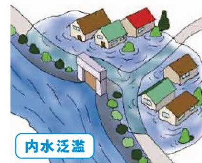
河川水位因大雨上涨导致排水困难,下水道与排水道等发生溢水。
