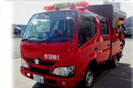
【小型動力ポンプ付積載車】
