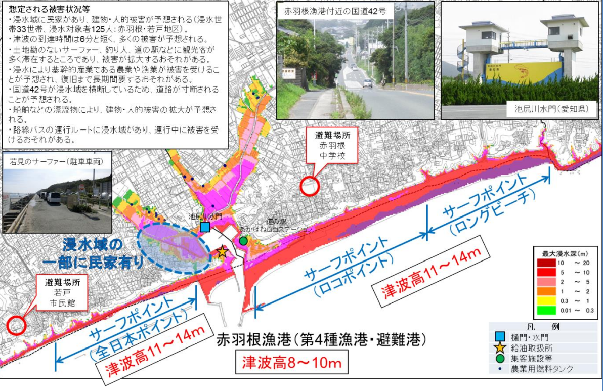
図 2-23 想定される被害状況等(赤羽根漁港周辺)
