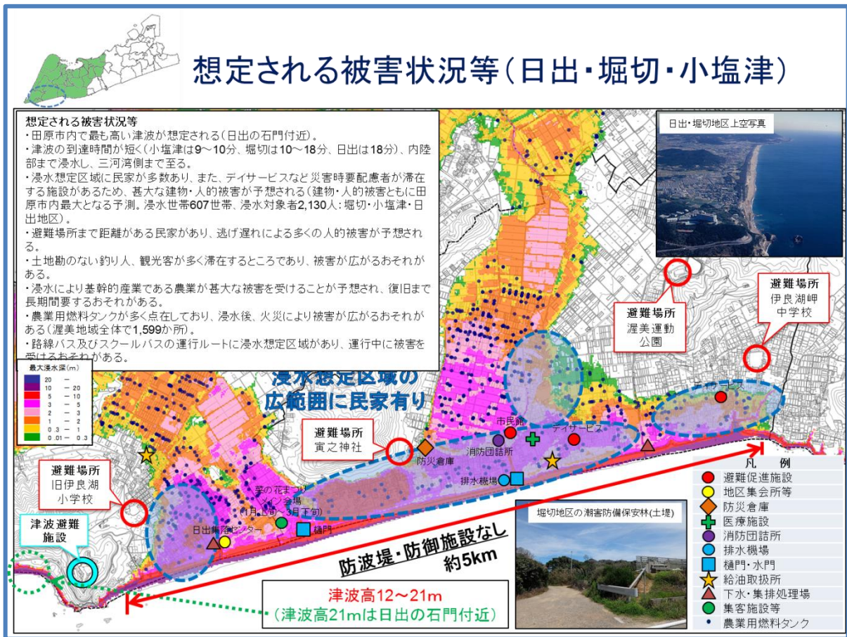
図 2-29 想定される被害状況等(日出・堀切・小塩津)
