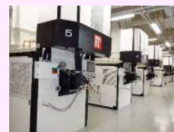
最新の排煙設備を備えた火葬炉
