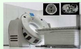
X線を使って、頭部や胸腹部の断面を撮影する装置
