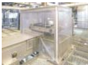
5 磁選機 ごみに混入した金属を選別し 回収
